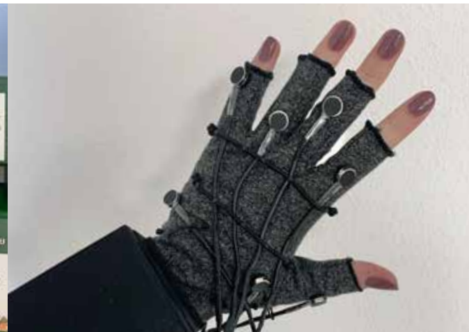
Prototyp: Vibrationshandschuh zur Vermittlung taktiler Reize (Foto: A. Kushnir)
